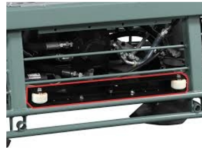
Detalle del sistema de soportes con ruedas para trabajar junto a la pared
